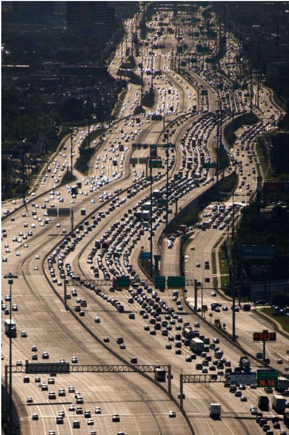
L'exemple de la Katy Freeway à Houston : malgré ses 26 voies elle n'a pas permis de résoudre les problèmes de congestion à cause du trafic induit (Source: Aliciak3yz , CC BY-SA 4.0, via
