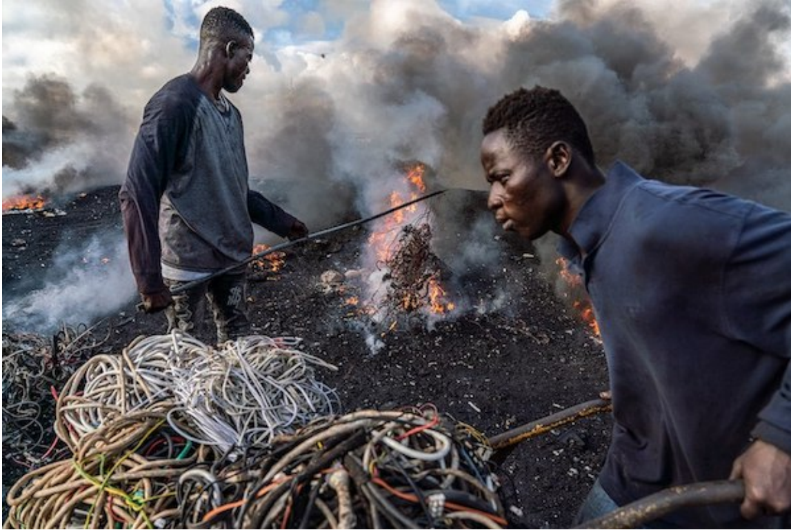
Incinération de câbles électriques pour en récupérer le cuivre à Agbogbloshie au Ghana (source : Muntaka Chasant, CC BY-SA 4.0, via Wikimedia Commons).
